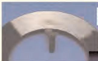
Sfiamature da degradazione termica, causata da attrito eccessivo nel punto d'iniezione.
