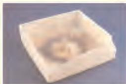
Esempi di pezzi con venature da degradazione.
